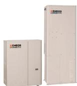
の商品化に世界で初めて成功しました。これらの家庭用燃料電池は、それぞれの燃料から取り出した水素と空気中の酸素の電気化学反応で発電し、それと同時に発生する熱を利用してお湯も作れる、とても効率的なコージェネレーションシステムです。送電ロスもなく、貯湯タンクに貯めたお湯も使えることにより、約80%と優れた総合エネルギー効率を達成でき、CO<sub>2</sub>の排出を大幅に削減できます。
