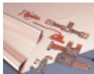
フレキシブルプリント 基板向け圧延銅箔
