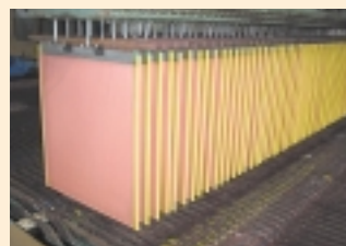
パーマメントカソード方式による電気銅
