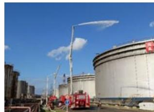
大型化学高所放水車（水島製油所）
