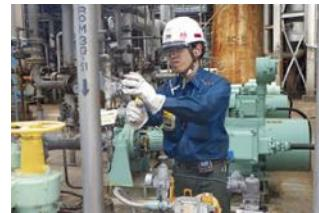
個人サンプラーを用いたばく露測定中の作業員
