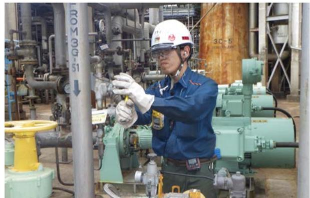
個人サンプラーを用いたばく露測定中の従業員
