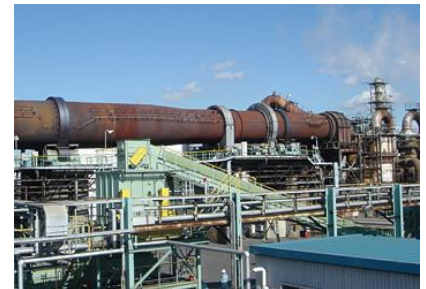
JX金属苫小牧ケミカル ロータリーキルン式焼却炉
