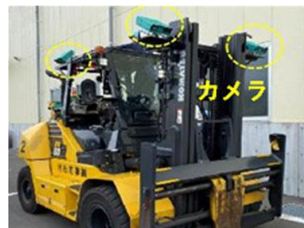
フォークリフトへのインテリジェントカメラ設置状況
