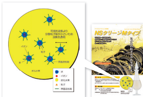
炭化水素の中にイオンを含む水滴 界面活性剤が水滴と粒子を分散
