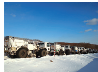
地震探鉱作業中の起震車
