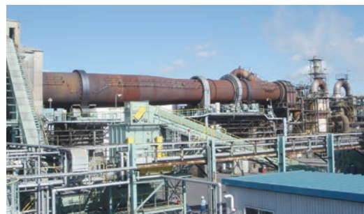
JX金属苫小牧ケミカル(株)ロータリーキルン式焼却炉
