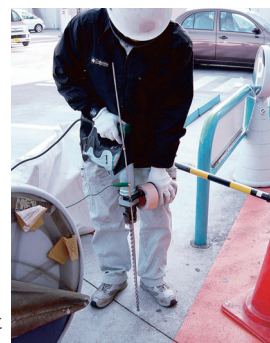
稼働中サービスステーションにおける土壌中ガス調査
