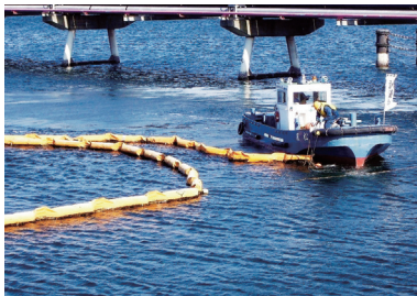
海洋汚濁防止訓練におけるオイルフェンス展張、油回収作業の様子
