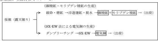
(注)・ダンプリーチング:鉱石を粉砕せず堆積させ、希硫酸を散布し、銅を浸出(リーチング)
